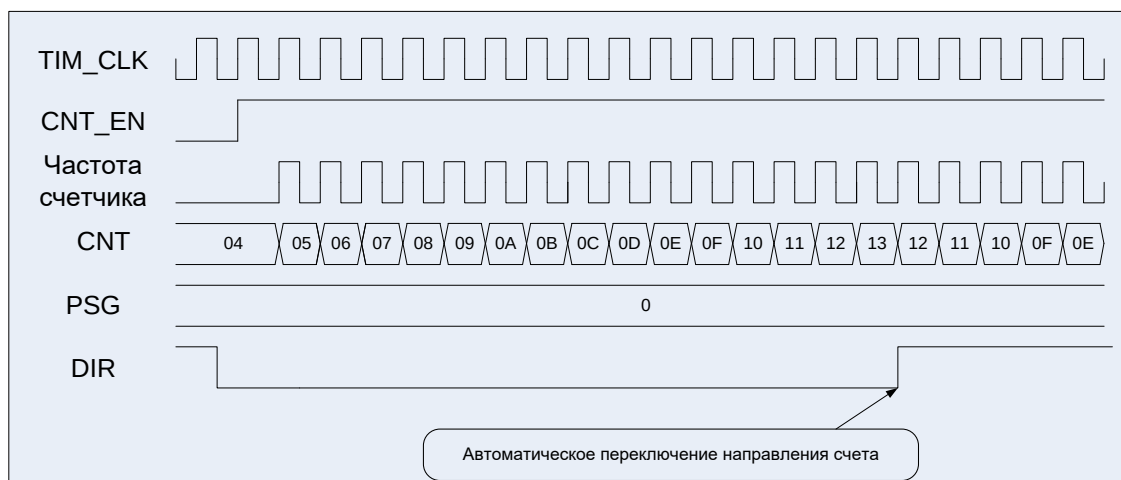
Рисунок 64 – Диаграммы работы таймера, счет двунаправленный, сначала прямой
