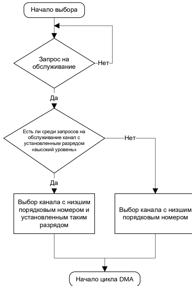
Рисунок 125 – Алгоритм выбора следующего канала для обслуживания
